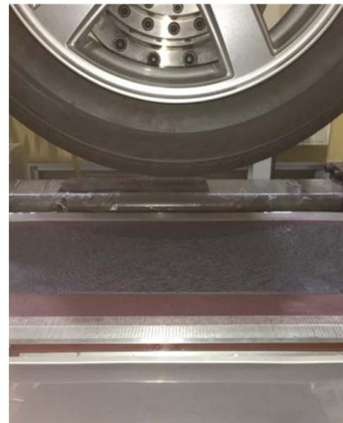
ベルト式試験機への適用例
